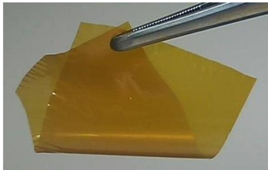
ベンゼン環とスルホン酸基だけから成る燃料電池用の薄膜
